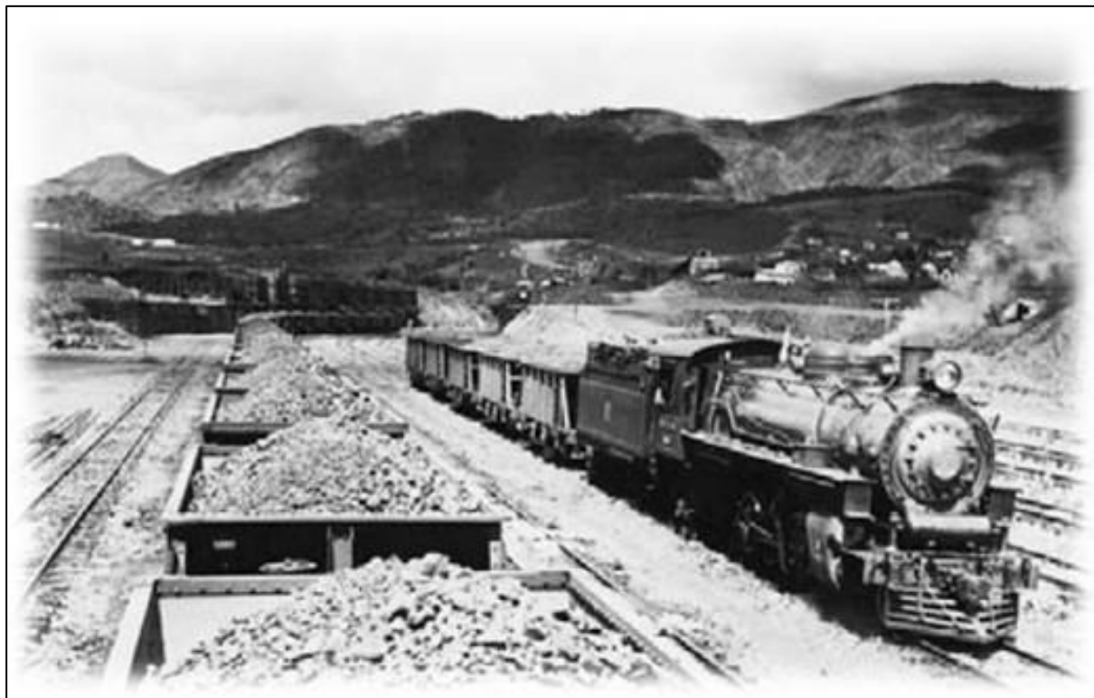
Figura 2. Estrada de Ferro Vitória/Minas – Locomotiva Mikado186 formando o trem de minério da EFVM no Pátio de Itabira, por volta de 1952 (Acervo Vale).
